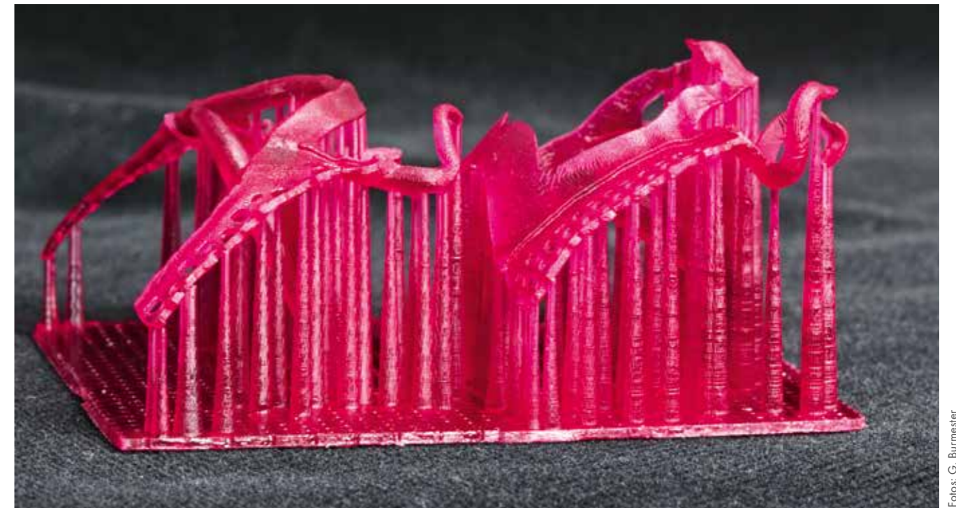
Fertig gedruckte Modellgüsse mit so genannten „Supports“, die nach dem Druck von den Einheiten abgetrennt werden.
